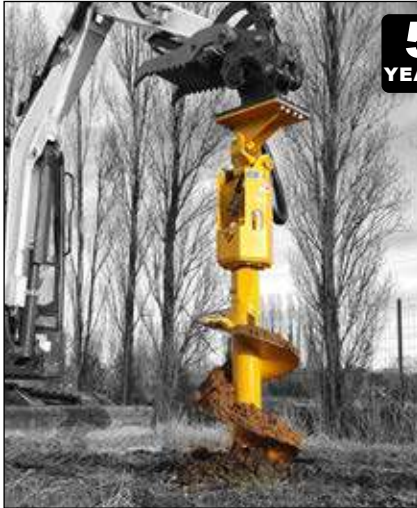
TMR 605 on mini excavator
