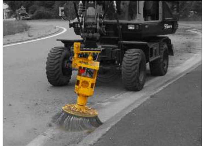
HERBIONET PE with brush Ø 500 mm
